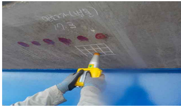
슈미트해머에 의한 반발경도 시험
